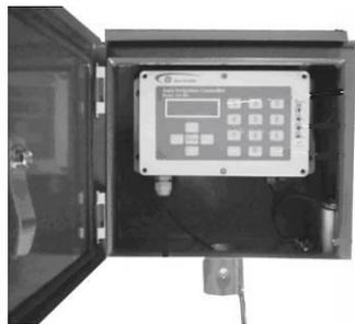
将电磁阀的连接线从箱体的进线孔穿进, 选择好连接端口, 并拔出插头
