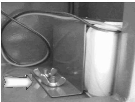
1、先拆掉如图箭头所示固定电池的螺帽, 卸掉固定电池的固定架
