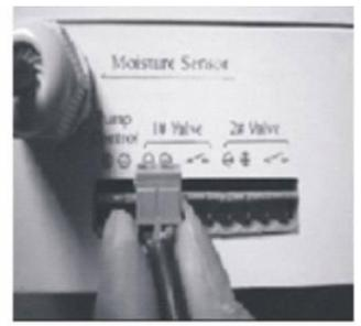
将接好线的插头按原位插好即可.(安装阀时, 要看阀的类型, 脉冲/12VDC 阀接带正/负的接口, 控制已有 AC 供电电源的阀就要接开关接口, 不允许接错)
