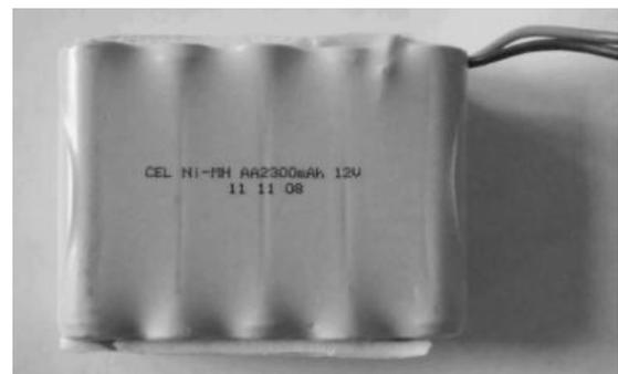
2、卸掉旧电池, 安装上同样规格电池, 把电池上下两面贴上泡沫棉或绝缘皮, 然后把电池用固定架固定. 注意: 接线端红线接正极, 黑线接负极。
