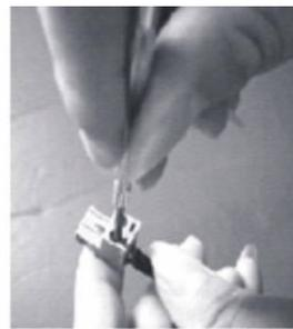
参考端口标识的正/负极, 按红线接正, 黑线负的规定将电磁阀线接到拔下的插头上(未标明正/负的端口, 可自由接线)
